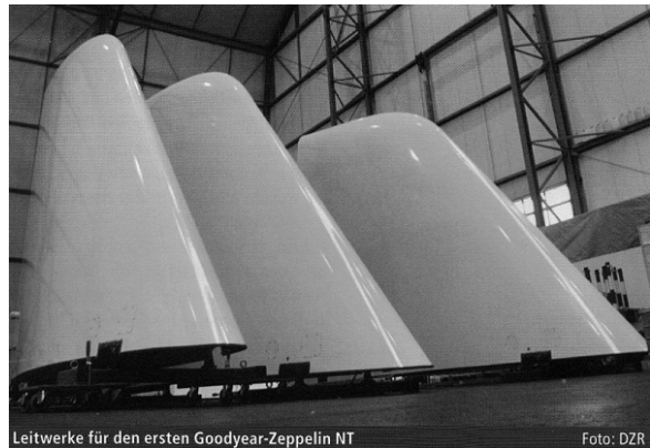
Tailfins for Goodyear’s first Zeppelin NT Photo courtesy of Deutsche Zeppelin Reederei
